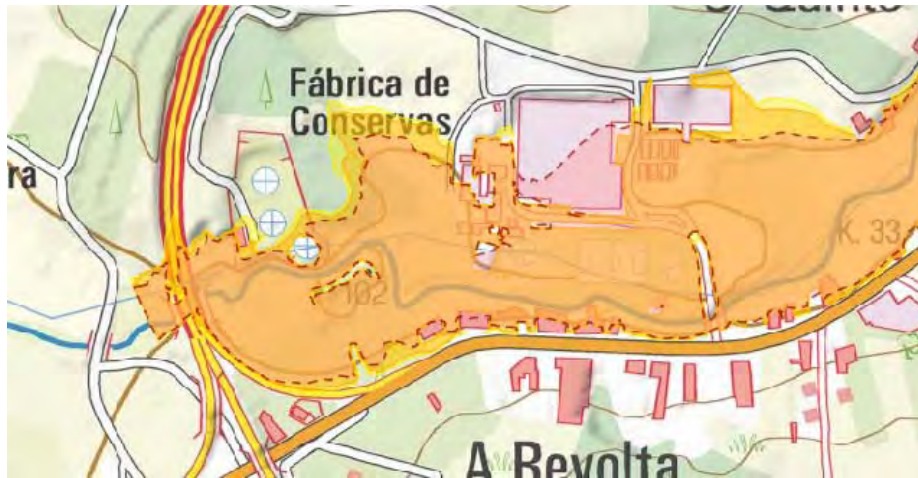
Mapa de ARPSI Río Anllóns. Zona de flujo preferente y láminas de inundación. Aguas de Galicia
